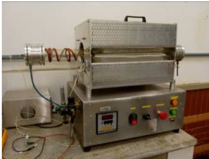
Figura 4.2 – Reator de leito fixo empregado nos experimentos de pirólise de biomassa
