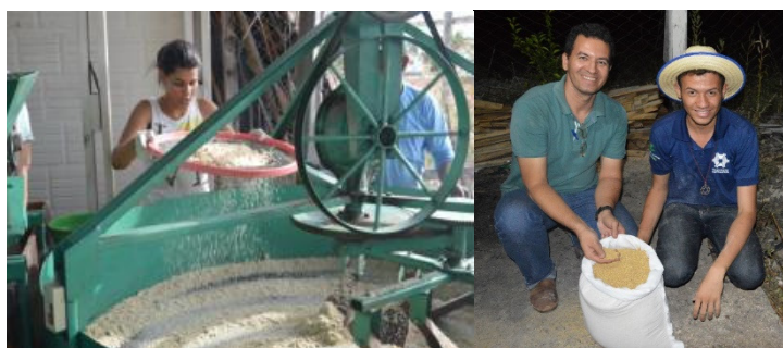
Figura 3. Da esquerda para a direita, 2º processo de ralação (peneiração para deixar a massa mais solta), após torrefação até o ponto desejado, temos a farinha de batata-doce como produto final
