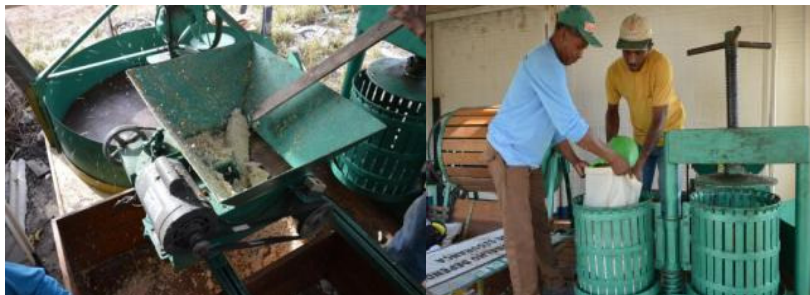
Figura 2. Da esquerda para a direita, processo elétrico de ralação e prensagem das raízes de batata-doce
