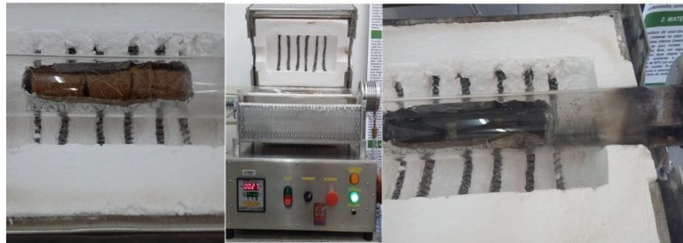
Figura 2: Processo de pirólise do briquete da fibra de coco
