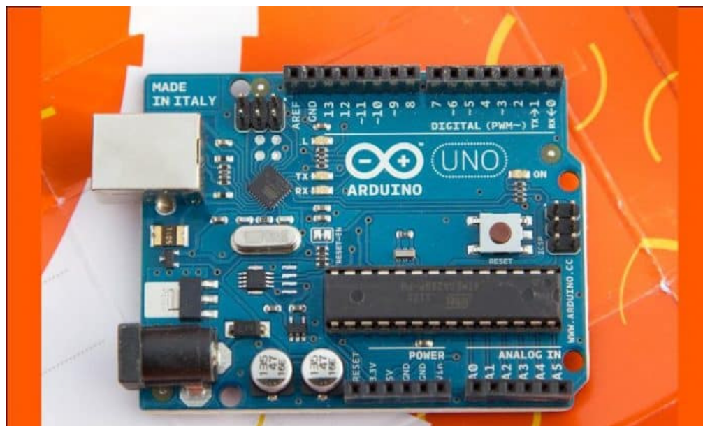
Figura 3 – Modelo original da placa controladora arduino.
