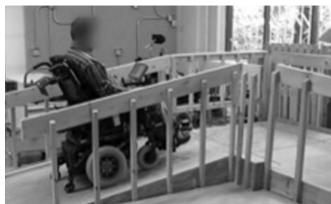
Figura 4: Testes de Movimentação da RWST (Fonte: BOUCHER et al., 2013).
